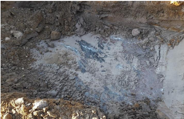
Valokuva 3. Kuopassa VAH 6 tuli kalliopinta vastaan 0,5 m syvyydellä.
