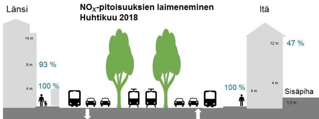
KUVA 17. Typenoksidipitoisuuksien laimeneminen länsipuolella korkeussuunnassa ja itäpuolella sisäpihalla verrattuna katutilaan. Mittausjakso on 1 kk (Huhtikuu 2018). Sensoreista L14 ja SP4 ei saatu dataa.
