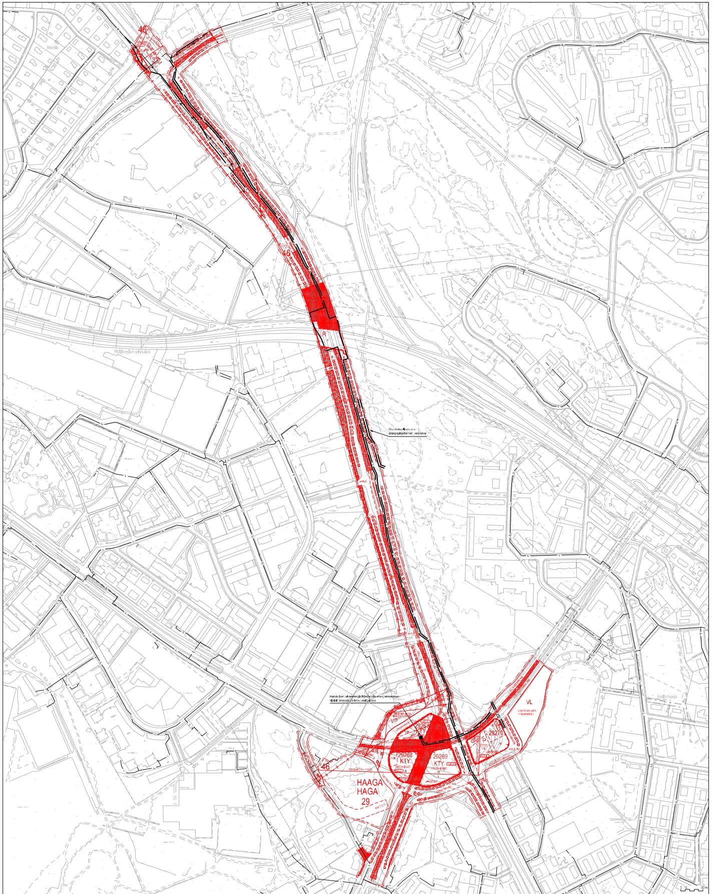
Haagan ympyrä, Vihtintie Kaukolämpö, Kaukojäähdytys ja Kaasu 1:3000
