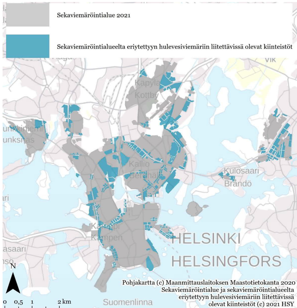
Kuva 2.2 HSY:n sekaviemäröintialue 2020. Kuvassa turkoosilla esitetyt kiinteistöt on mahdollista liittää myös eriytettyyn hulevesiviemäriverkostoon.
