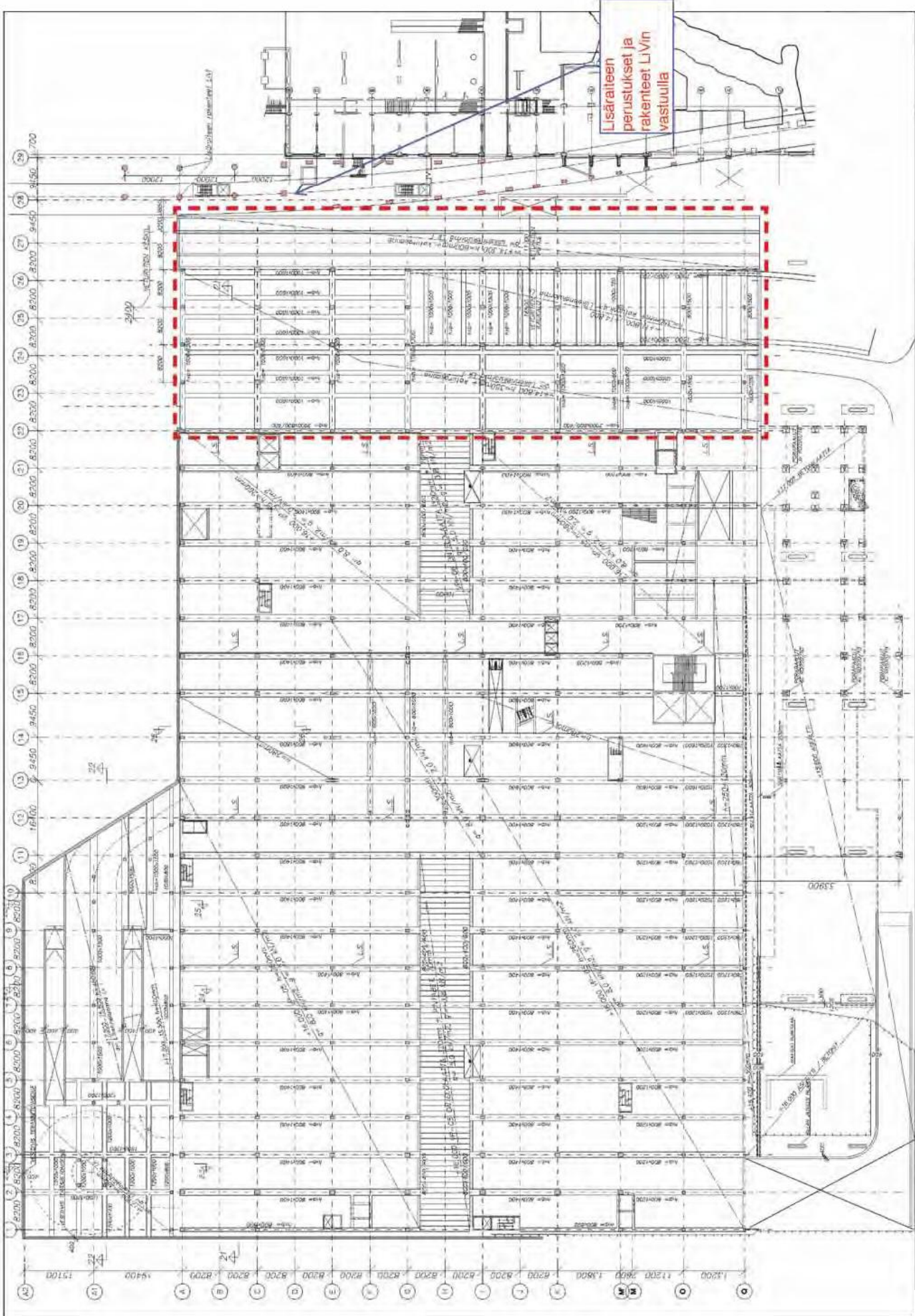
13.18. Taso +15.000 runkorakenteet, 1:750 (Yliäpito ja peruskorjaus)
