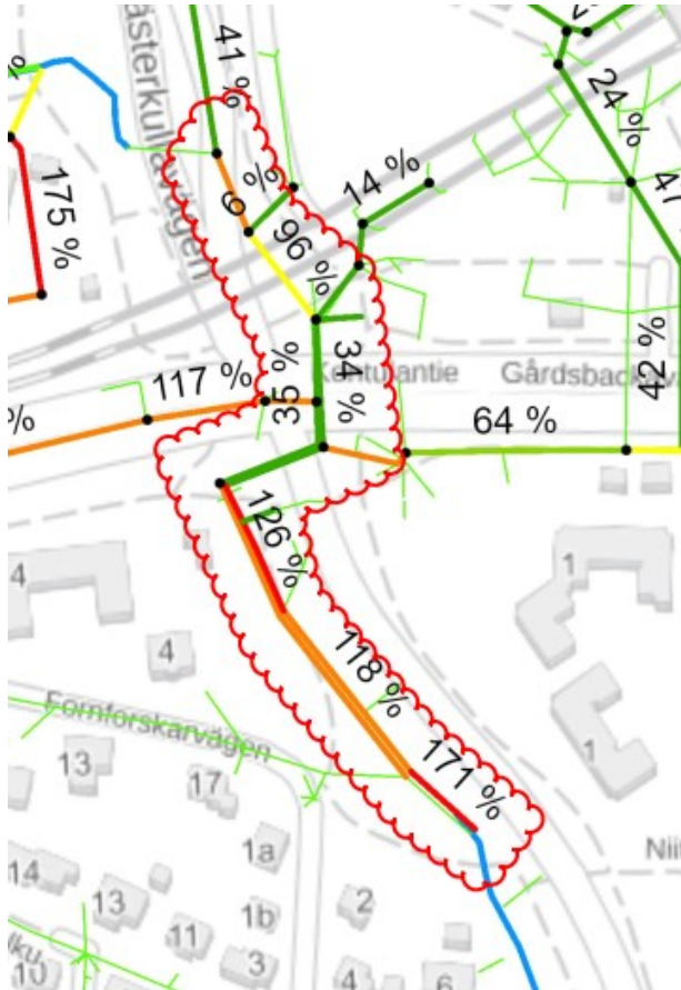
Kuva 5. Mellunkylänpuron putkitettu osuus ja sen kapasiteetin ylittävät osuudet (oranssi ja punainen).
