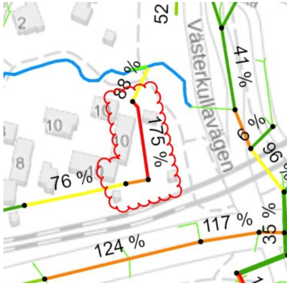
Kuva 7. Aartenetsijänkujan hulevesiviemäriin padottava osuus.
