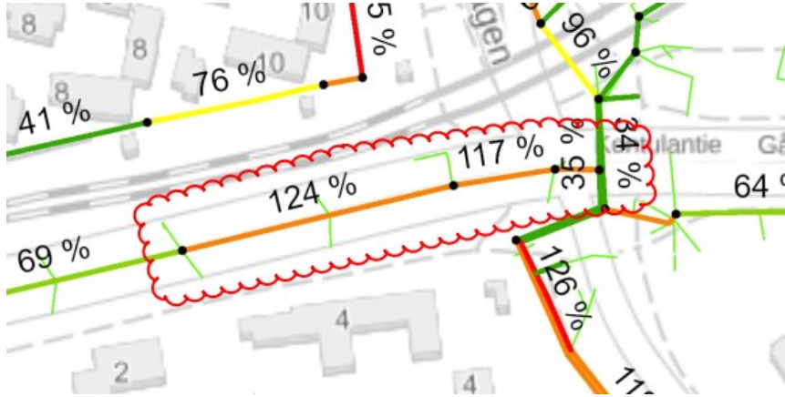
Kuva 6. Kontulantien hulevesiviemärin kapasiteetin ylittävä osuus.
