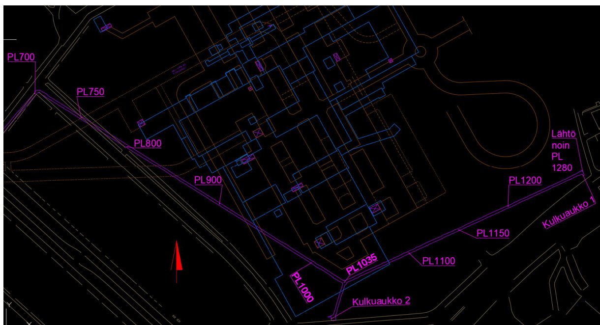
Kuva 1. Pysäköintihallit, avolouhinta ja jätevesitunneli. Näkyvien paalujen sijainti arvioitu kuvaan, tämän perusteella lisätty paalutusta. Suunnitellun avolouhinnan rajaukset sinisellä ja maanalaiset tilat ruskealla.
