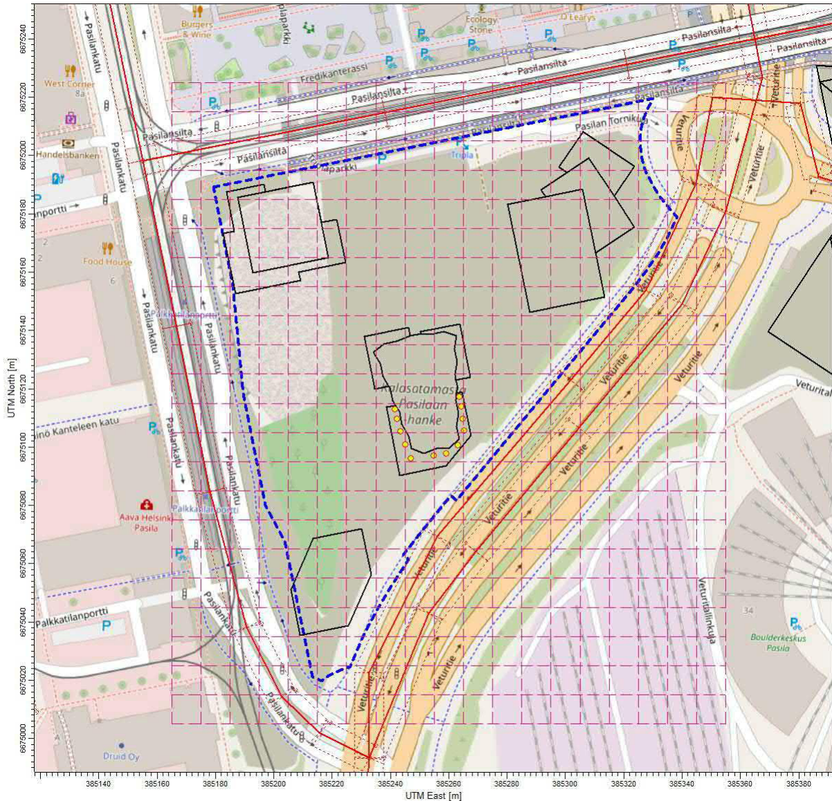
Kuva 3-4. Laskentapisteiden suorakulmainen hila (punainen katkoviiva) ja erilliset laskentapisteet keskimmäisen tornin terassitasolla (keltaiset ympyrät). Kohdealueen rajat merkitty sinisellä katkoviivalla.
