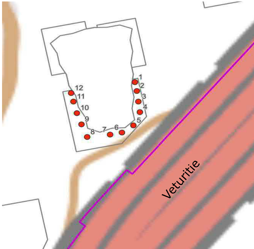
Kuva 4-28. Keskimmäisen tornin terassitason erilliset reseptoripisteet.
