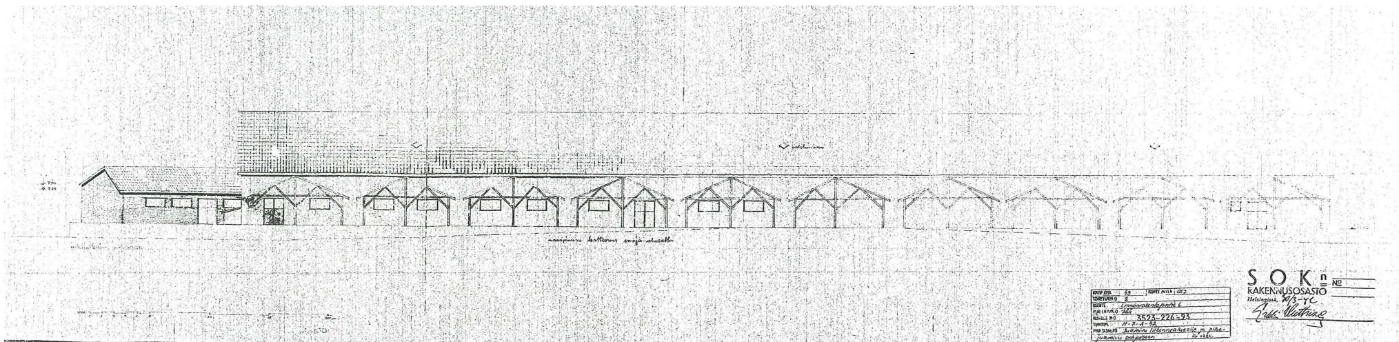
Ensimmäisen rakennusvaiheen julkisivu pohjoiseen, Erkki Huttunen 1942. Piirustuksessa näkyy alkuperäinen pohjoispuolen pitkä lastauskatos, joka toteutettiin puurakenteisena todennäköisesti sota-ajan materiaalipulasta johtuen. Kuvälähde: Rakennusvalvonnan arkisto.
