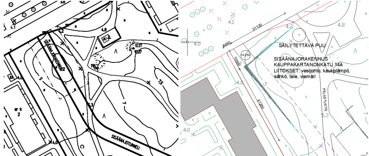
Kuvat 21 ja 22. Otteet Kauppakartanonkadun väestönsuojan ajoiteyksistä vuosien 2006 ja 2009 suunnitelmissa (Helsingin kaupunki, Kalliosuunnittelu Oy/Rockplan Ltd 18.4.2006 ja 23.10.2009)
