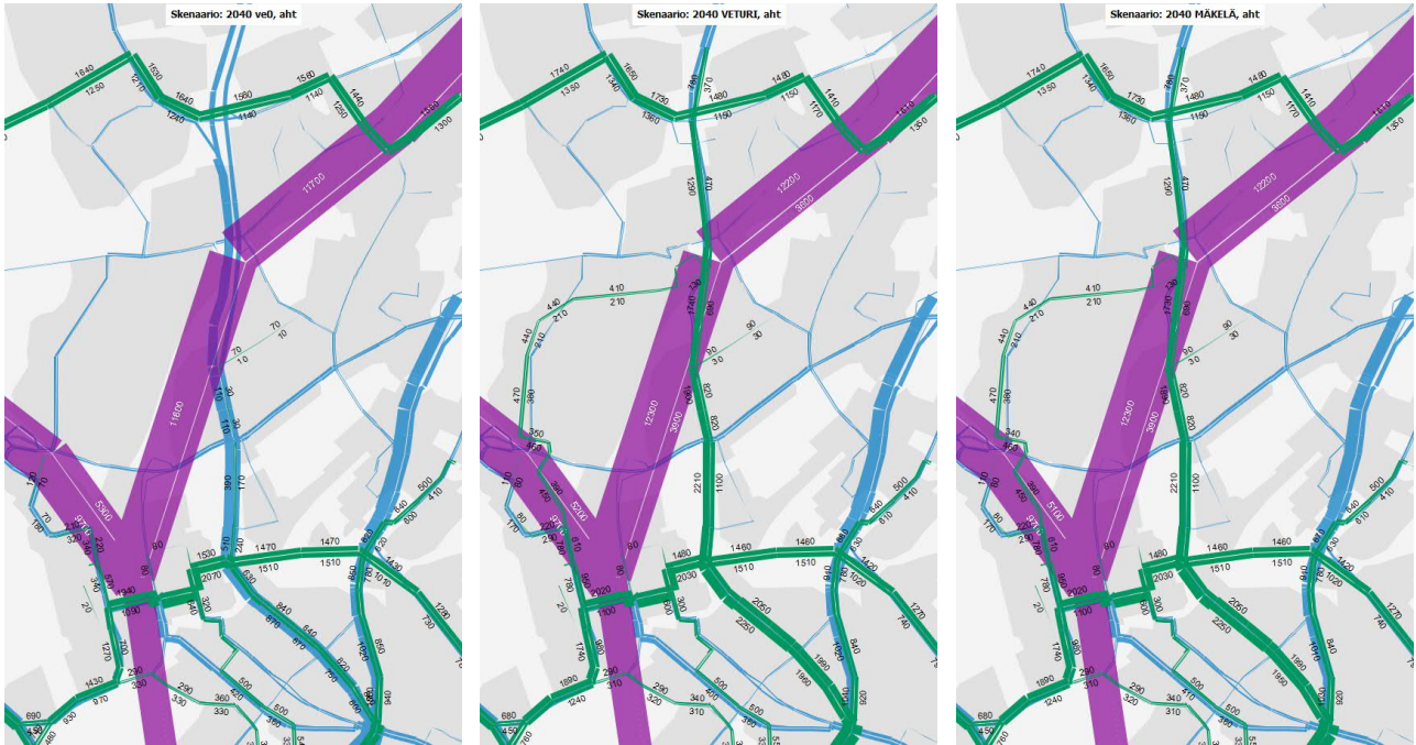
Kuva 42. Joukkoliikenteen matkustajamäärät aamuhuipputuntina 2040 vaihtoehdoissa ve0 (moottoritie) sekä Mäkelänkadun vaihtoehdoissa Veturi ja Mäkelä. Violetti kuvaa junaa, vihreä raitioiteitä ja pikaraitioiteitä ja sininen bussia.
