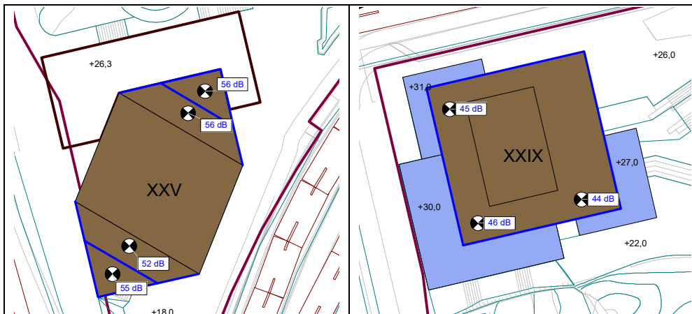
Kuva 2. Eteläisimmän tornin kattoterasseille kohdistuvat päiväaikaiset keskiäänitasot.
