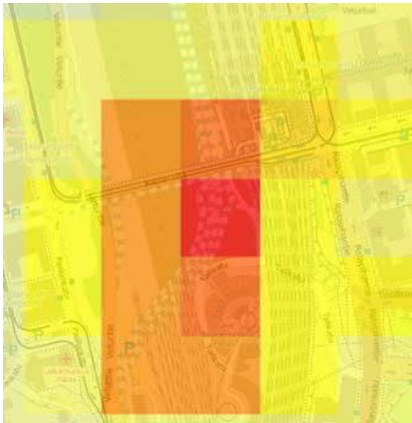
Kuva 3-3 Lämpösaarekeliöiden voimakkuus Keski-Pasilan alueella. Veturitiellä Itätornin ja Keskimmäisen tornin alueella on punaisella merkitty kohta, mikä kuvastaa erittäin suurta lämpösaarekeliötä mallinnuksen perusteella 46 .
