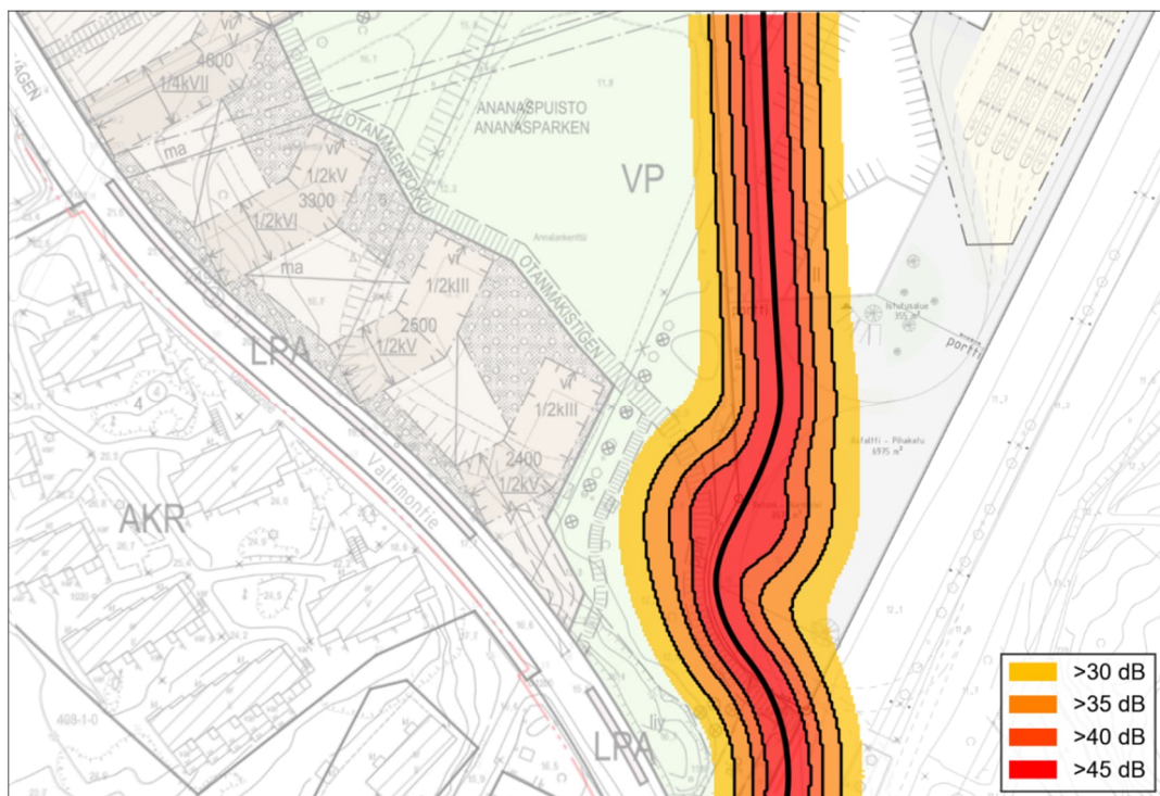
Kuva 5: Runkomelumallinnuksen tulos varikkoalueella kulkevalle raitiotieliikenteelle, esitettynä ase-makaavaluonnoksessa ja varikon asemapiirroksessa asuinrakennusten 1. kerroksen osalta. Kuvassa on esitetty alueet, joissa runkomelu ylittää mallinnuksen perusteella 30 dB runkomelutason.
