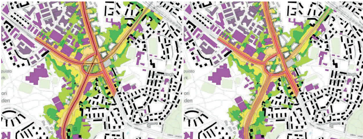
Kuva 8. Vihdintien liikenneympyrä. Vasemmanpuoleisessa kuvassa on esitetty keskiäänitasot tilanteessa, kun kaikki liikennemelulähteet on huomioitu. Oikeanpuoleisessa kuvassa esitetty keskiäänitasot tilanteessa, kun ainoastaan tieliikenteen aiheuttamat melutasot on huomioitu.
