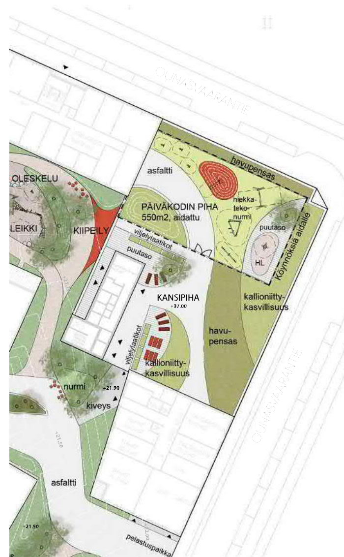
Vaihtoehtona sijoittaa pysäköintihallin kattopihalle päiväkodin piha 1:500
