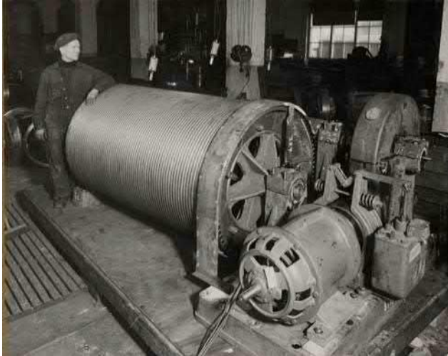
Mies seisoo hissikoneiston takana. Hissikoneisto HM 5c/1 8 tonnin hissiin H3399 tela 1100x1750 mm 3:lla uralla nopeus 0,25 m/sek (Suomen kaapelitehdas, Salmisaari). Kuva vuodelta 1942. /Elka
