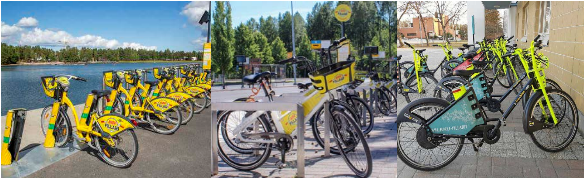
Kuva 8. Asemien teknisiä toteutustapoja. Vasemmalla on esitetty Helsingissä ja Espoossa käytössä olevat kaupunkipyörätelineet, keskellä Vantaan kaupunkipyörien runkolukitustelineet ja oikealla Kuopiossa Viikku-fillarien kevyet asemat. Kuvälähteet: Espoon kaupunki 2023, Vantaan kaupunki 2024, Viikkosavo 2024.
