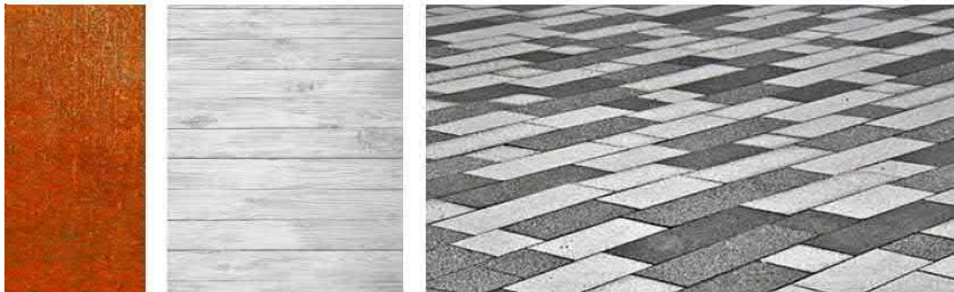
Kävelykadun materiaaleina corten-teräs, harmaantuva puu ja harmaasävyidet luonnonkivet.
