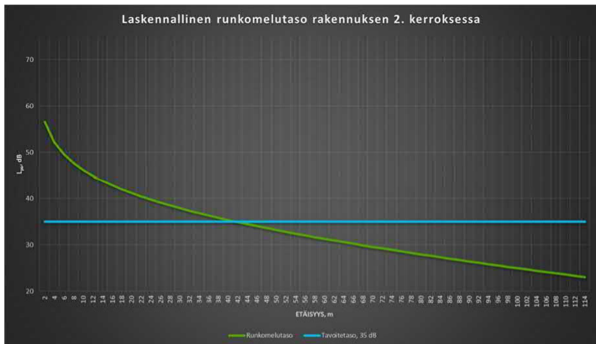
Kuva 16. Runkomelutaso rakennuksessa kerroksessa 2 vaihtoehdoissa a (suora eristämätön rata) ja c (vaihdealue, eristys -10 dB)
