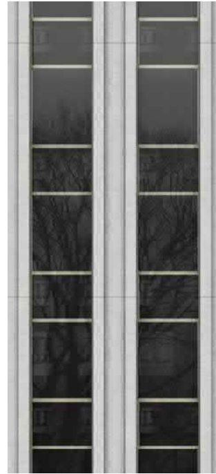
Betonikuorijulkisivu, välisat julkisivulasia korkea osa, krs. 9 - 19
