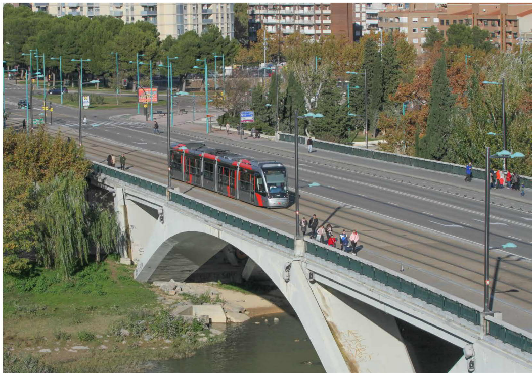
Kuva 25 Pikaraitiotie Zaragozan kaupungissa. Kaupungin historiallisen keskustan alueella linjalla ei ole ajolankoja. (kuva: Davy Beilinson)
