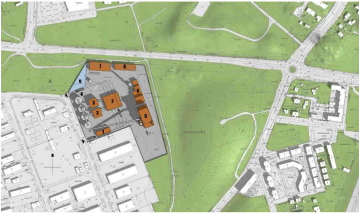
Kuva 5-3 Sijoitusvaihtoehdo VE1b, biomassaa ja jäteperäisiä kierrätyspolttoainelajeita käyttävän lämpökeskuksen alustava layout (Virkkunen&Co 2018).
