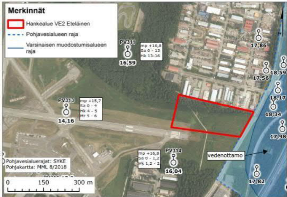
Kuva 11-6. Pohjavesipinnat ja kairaushavainnot vaihtoehdon VE2 eteläinen ympäristössä. Kuvan oikeassa laidassa on esitetty myös Tattarisuon vedenottamoalueen sijainti (Helsingin kaupunki, 2016: Ramboll Finland Oy).
