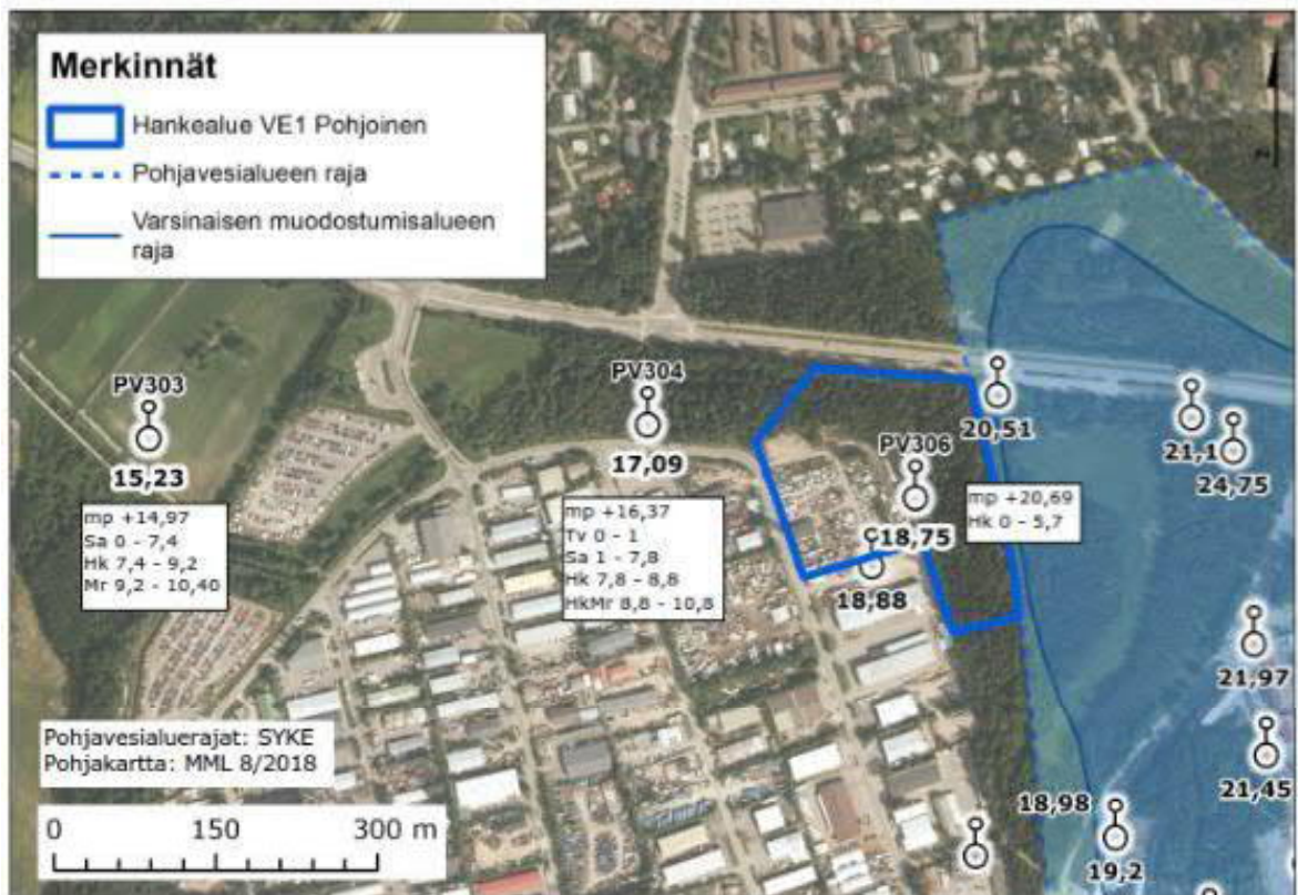
Kuva 11-5. Pohjavesipinnat ja kairaushavainnot vaihtoehdon VE1 pohjoinen ympäristössä (Helsingin kaupunki, 2016; Ramboll Finland Oy).
