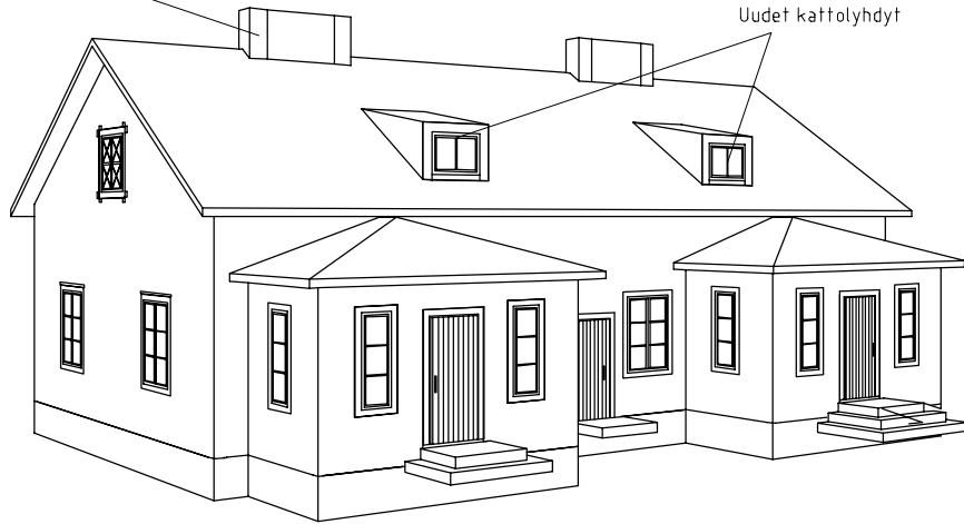
KATTOLYHDYT, MASSOITTELU SISÄÄNKÄYNTIJULKISIVU, RAK 2
