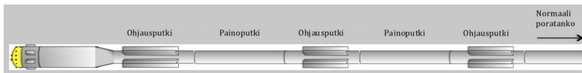
Kuva 10. Periaatekuva ohjurien käytöstä, porakruunu on kuvan vasemmassa reunassa [7].
