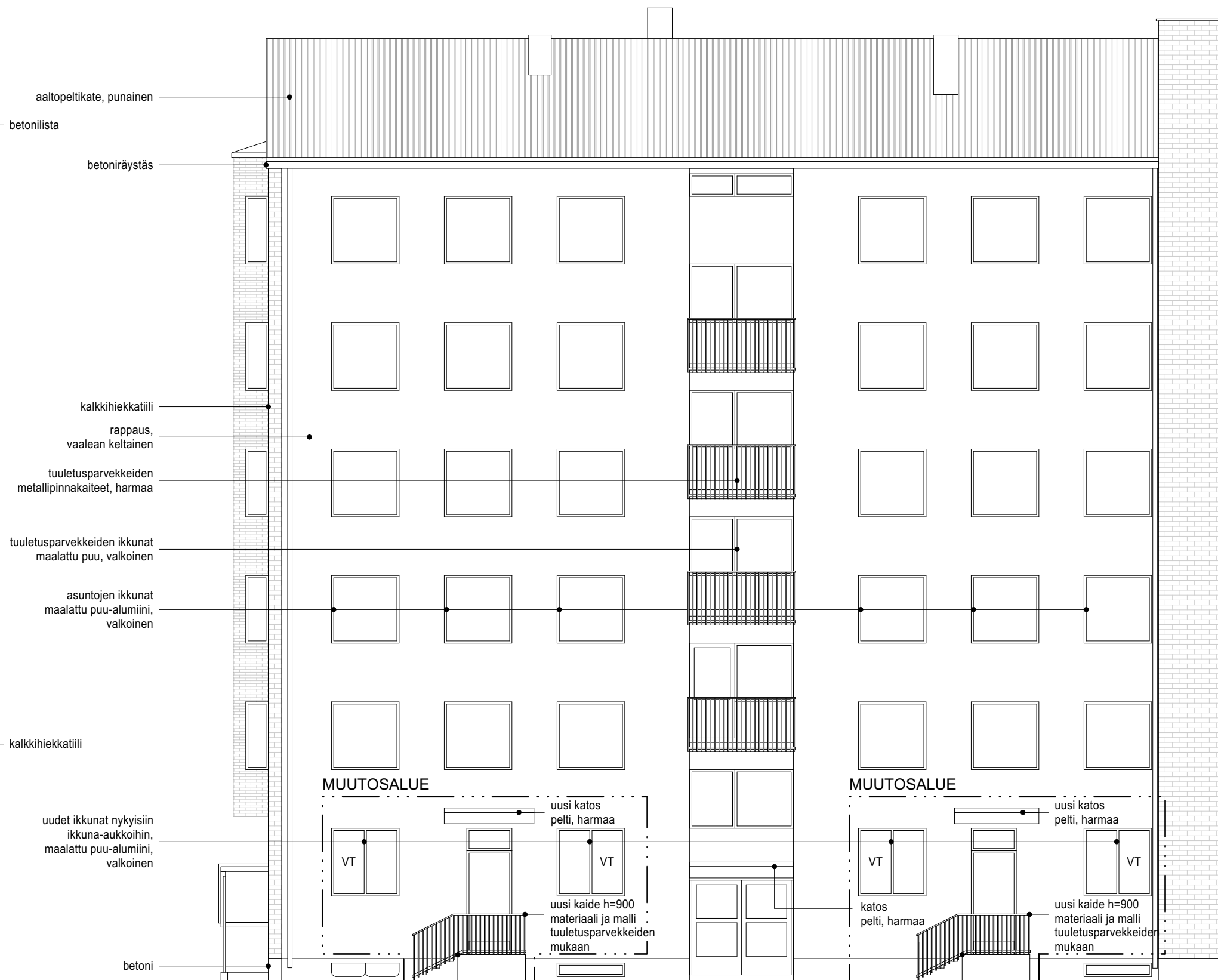
JULKISIVU PIHALLE, KOILLINEN
