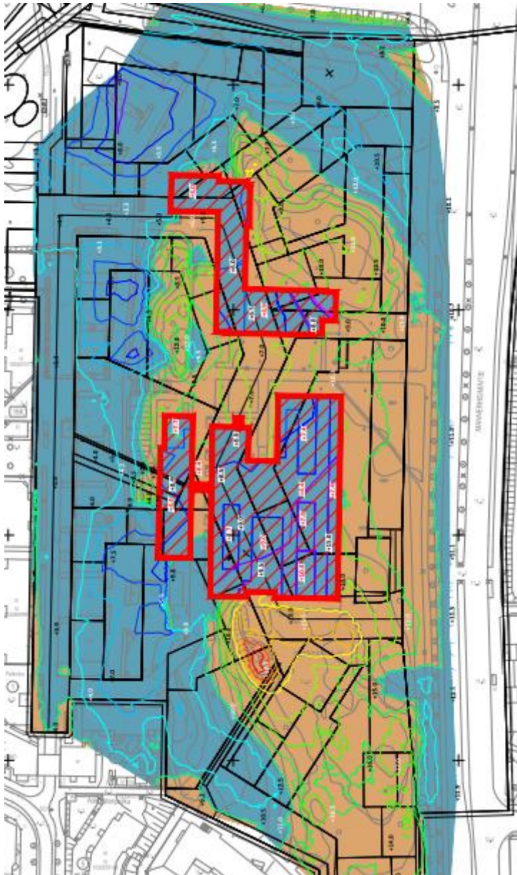
Kuva 1. Massat ja purettavat rakennukset
